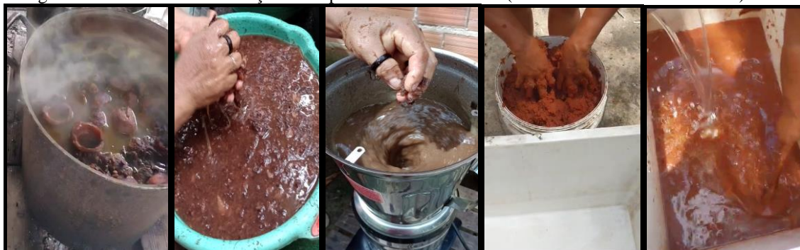
Fotografia 54: Processo de Produção do Papel Artesanal de Miriti (cozimento a mistura da massa).
